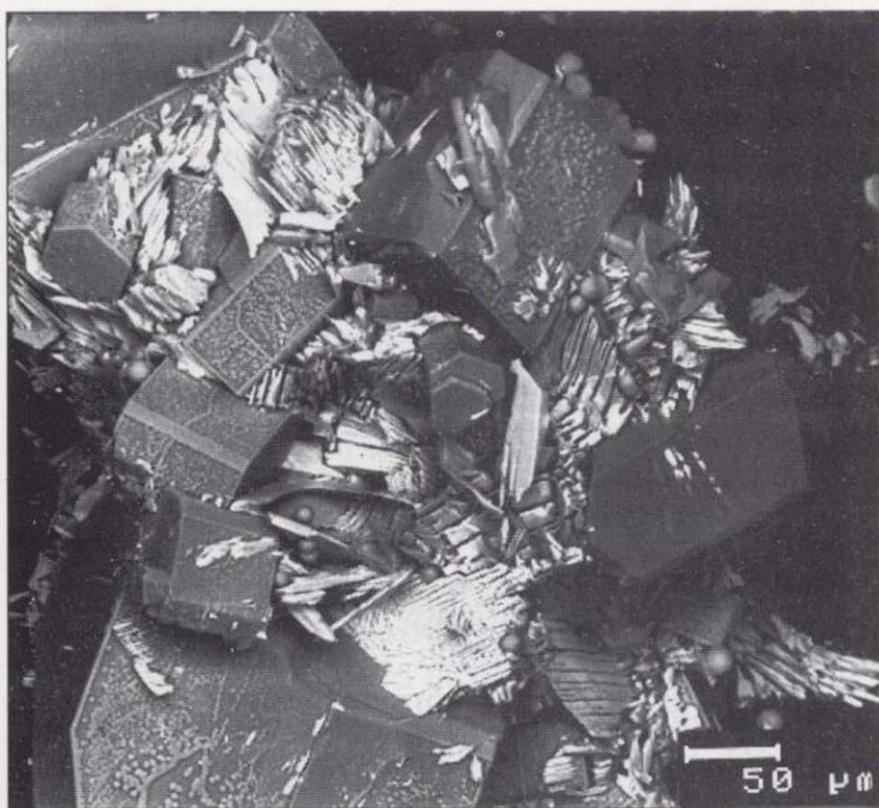
Figura 3. Mezcla sólida obtenida en los crisoles a la finalización del ciclo térmico, detalle observado con MEB.
